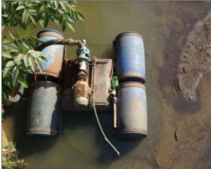
**Figura 25** - Sistema de captação de água
